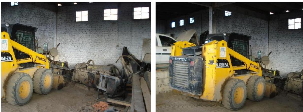
Varredeira mecânica com escova desconectada sem uso específico
